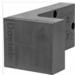
Staffe di montaggio pannelli TRA-WIK®-PU sono previste per il montaggio esterno di elementi senza ponti termici in sistemi di isolamento termico, pareti ventilate, sistemi di isolamento interno, ecc. Staffe di montaggio pannelli TRA-WIK®-PU sono realizzati in schiuma poliuretanic rigida imputrescibile, senza CFC, tinta in massa in colore nero con tre rondelle schiumate.
