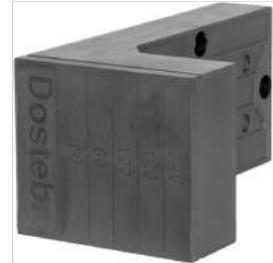
Staffe di montaggio pannelli TRA-WIK®-PU sono previste per il montaggio esterno di elementi senza ponti termici in sistemi di isolamento termico, pareti ventilate, sistemi di isolamento interno, ecc. Staffe di montaggio pannelli TRA-WIK®-PU sono realizzate in schiuma poliuretanica rigida imputrescibile, senza CFC, tinta in massa in colore nero con tre rondelle schiumate.
